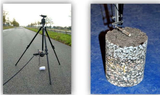
Slika 6: Merenje akustične impedanse na terenu i na betonskim kernovima
