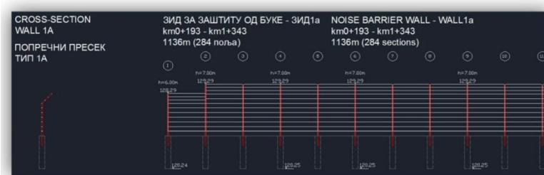
Slika 17: Crtež barijere za zaštitu od buke
