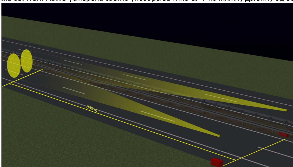
Слика 64. ИСПРАВНО усмерена светала упозорења типа СУ-7 на жијну даљину од 300 m
