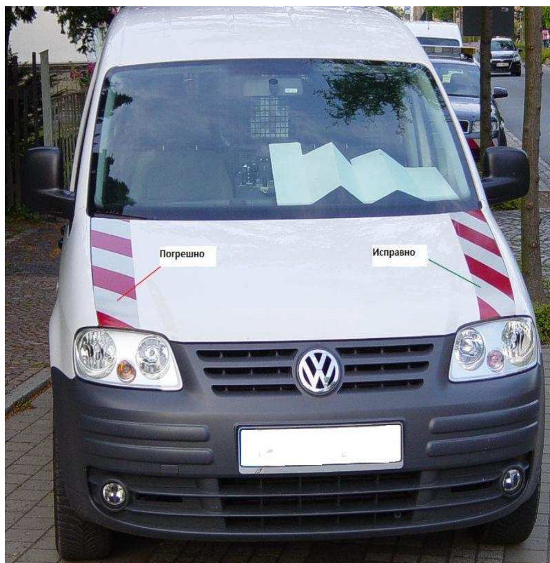
Слика 73. Пример погрешног и исправног означавања предњег дела возила
