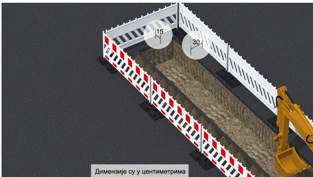
Слика 92. Минимална удаљења средстава за ограђивање од ивица ископа дата у cm
