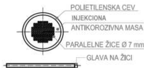
Slika 9.2.37: Presek kabla od paralelnih žica
