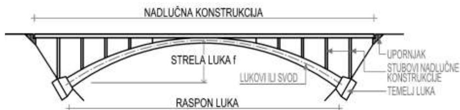
Slika 9.2.17: AB uklješteni lukovi
