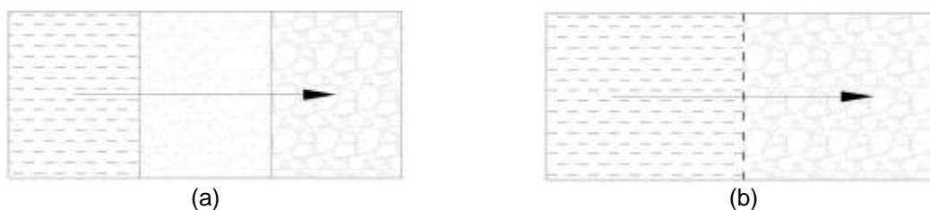
Slika 8.1.4.2: Uloga filtracionog sloja u zemlji (a) – klasični filter, (b) – filtracioni geosintetik
