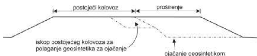
Slika 8.1.4.19: Korišćenje armaturnog geosintetika ispod nasipa pored priključka novog nasipa i novog kolovoza na stari kolovoz.
