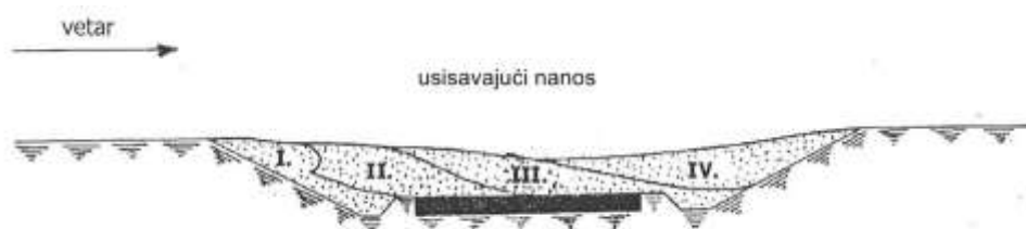
Slika 7.3.3.1: Postepeno povećavanje snežnog nanosa u useku
