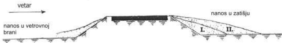
Slika 7.3.3.3: Odlaganje snega uz niski nasip
