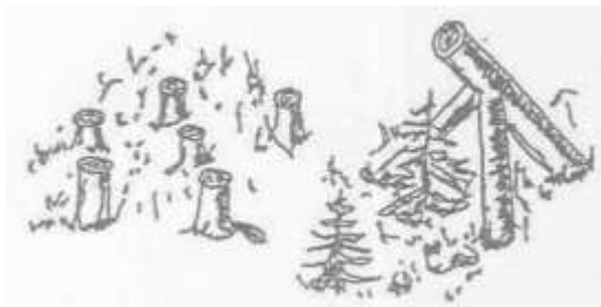
Slika 7.3.2.4: Zaštita rastinja od posledica klizanja i odronjavanja snega jednostavnim potpornim konstrukcijama koje povećavaju hrapavost površine
