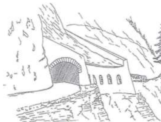
Slika 7.3.2.3: Galerija štiti put od odronjenog kamenja i snežnih usova
