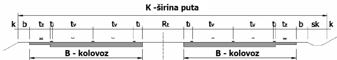
Slika 4.2.20: Standardni sastav površina u profilu puta sa kolovozima razdvojenim prema smeru upravljanja (autoputevi)
