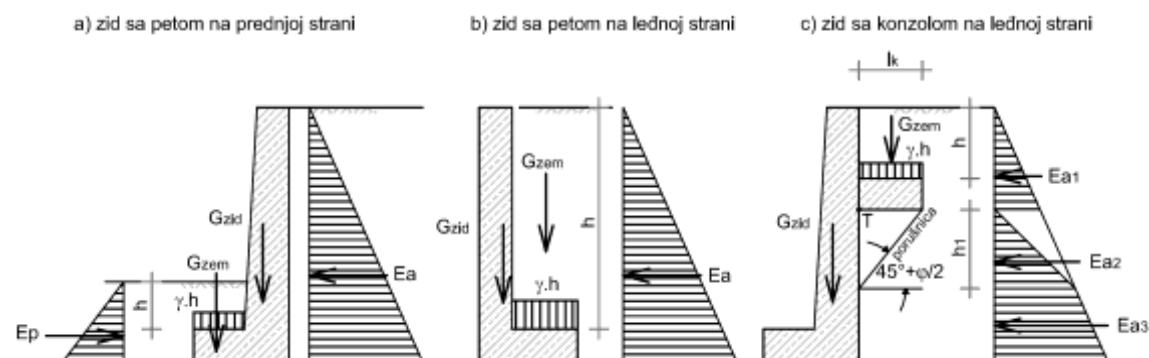
Slika 10.4.34: Opterećenja gravitacionog zida
