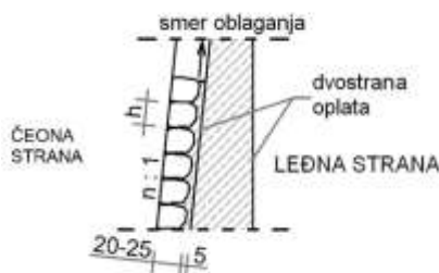
Slika 10.4.14: Detalj betonskog zida sa naknadnim oblaganjem
