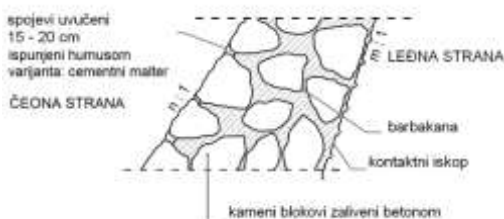
Slika 10.4.4: Detalj izrade kamenog gravitacionog zida
