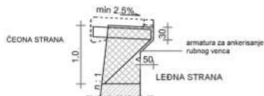
Slika 10.4.17: Detalj krune betonskog gravitacionog zida
