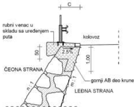
Slika 10.4.6: Detalj krune potpornog kamenog gravitacionog zida
