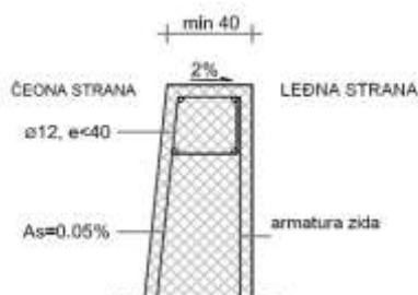
Slika 10.4.29: Detalj krune potpornog AB gravitacionog zida
